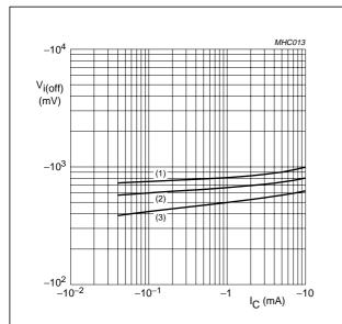
**TR2 (PNP);**  $V_{CE} = -5 \text{ V}.$
